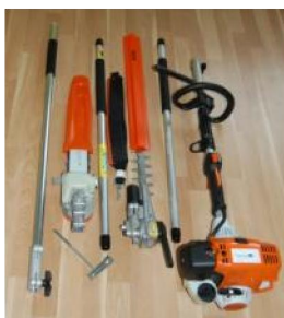
Instrumenti – elektriskās šķēres un ar motoru darbināms zāģis, dzīvžogu šķēres ar pagarinājumu augstu koku veidošanai
